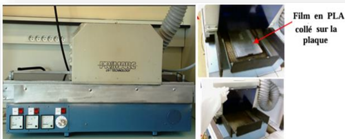
Figure III.1 : Schéma de l'appareillage du vieillissement sous UV (UMET Lille 1).
