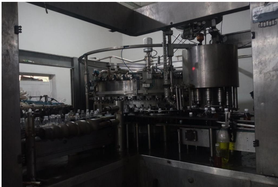
Figure II. 19:La machine de remplissage (Remplisseuse)
