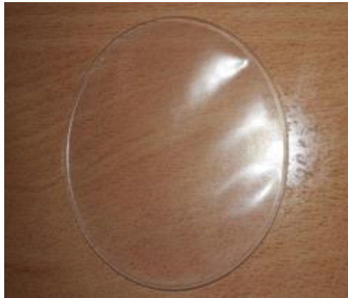
Figure II.3 : Film PLA pur obtenu par voie en solution
