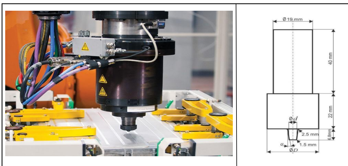
Figure II. 9 La machine et l'outil utilisés pour le processus FSW. [68]
