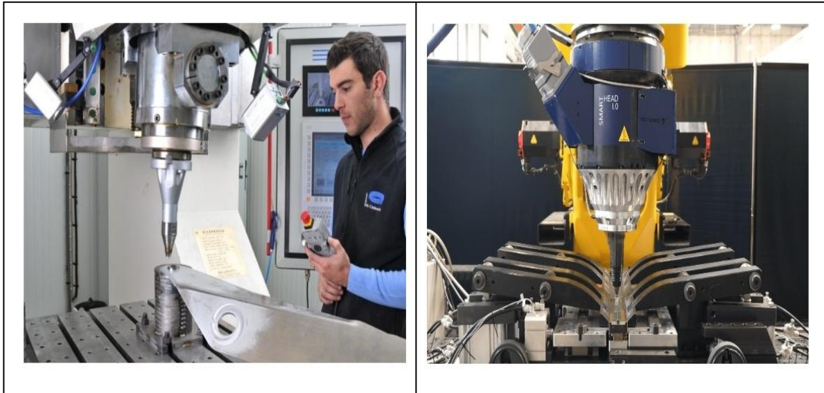
Figure I.9 Machines et équipement standard pour le soudage par friction malaxage. [12,10]
