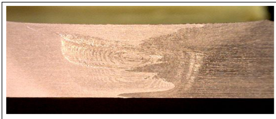
Figure I.13 Défaut à la racine du cordon. [31]
