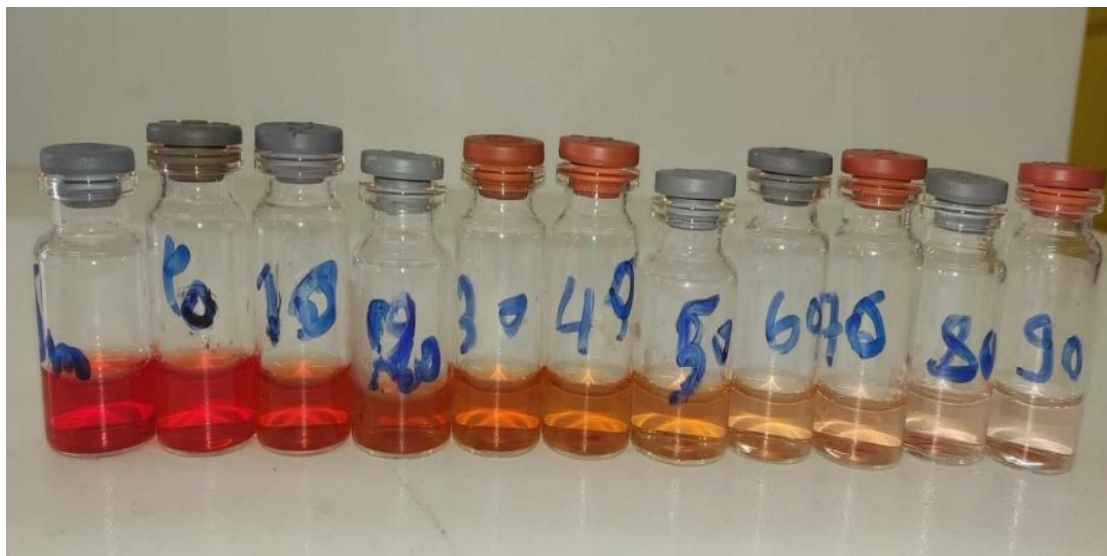
Figure V-14 : Dégradation du RC au cours du processus de photocatalyse.
