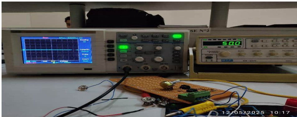
Figure II.41: Réponse du filtre Notch à 50 Hz.
