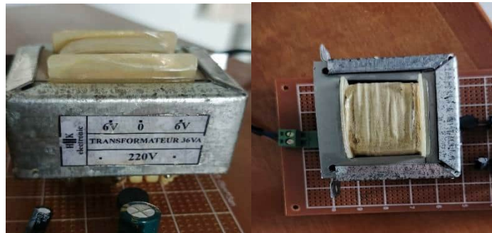
Figure II.9: le Transformateur utilisée pour cette alimentation stabilisée.
