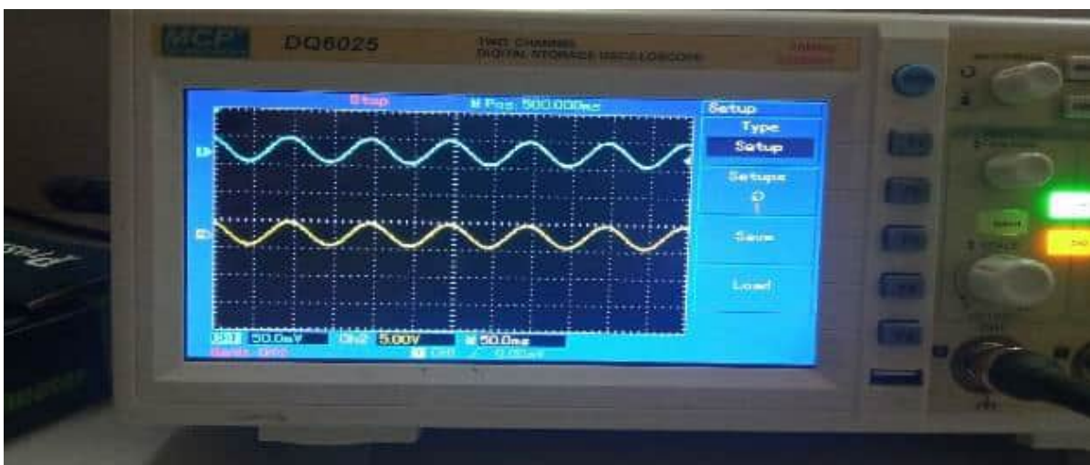
Figure II.28: visualisation du signal amplifié sur oscilloscope.
