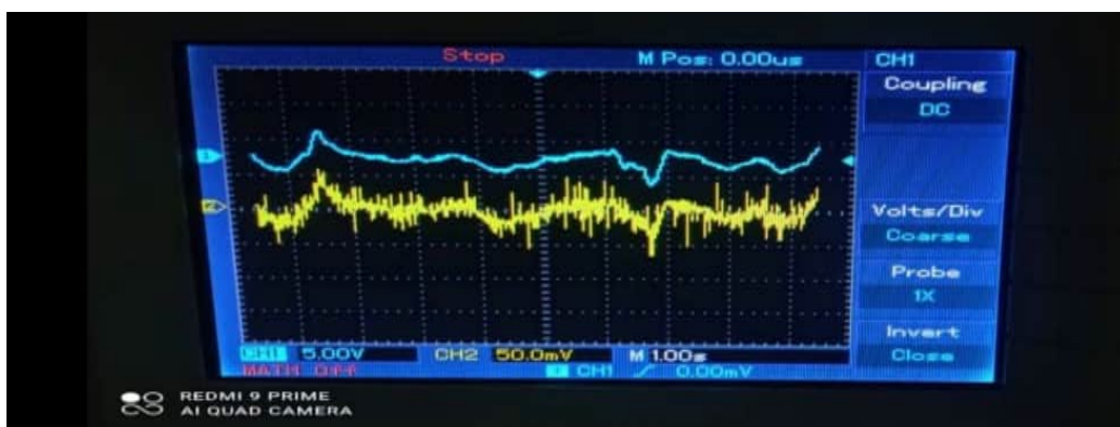
Figure II.47: Signal avant et après l'étape de conditionnement.
