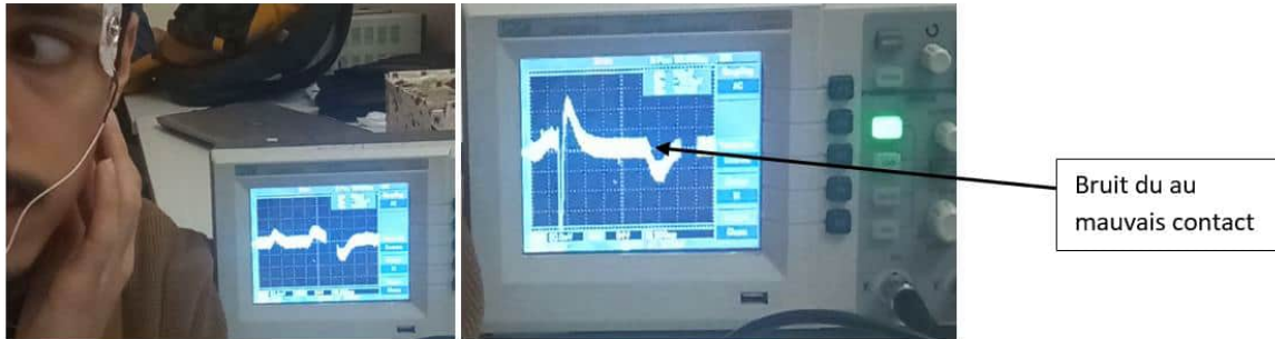
Figure III.4: Signal EOG acquis à l'aide de l'INA129 et un étage de mise en forme.
