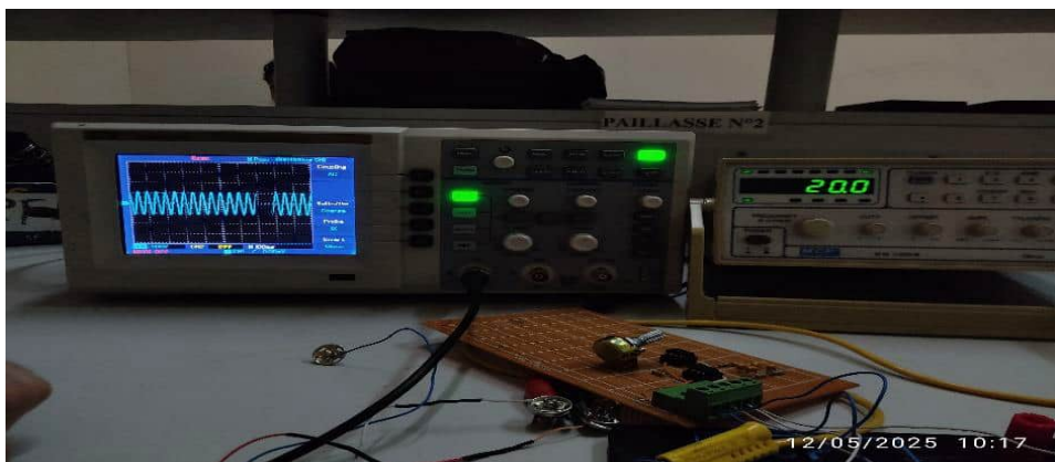
Figure II.42 : Réponse du filtre réjecteur à 20 Hz.
