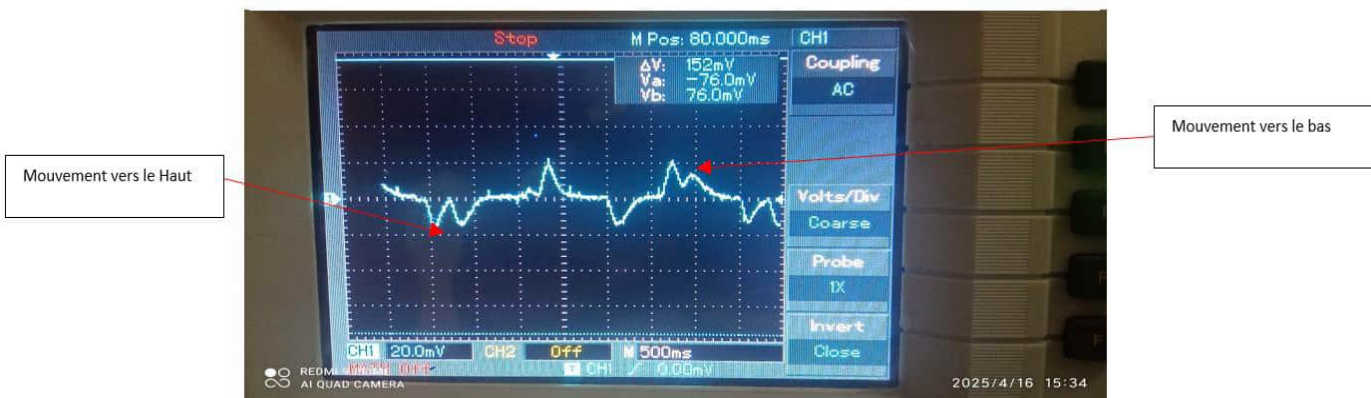
Figure III.6: EOG avec des mouvements haut et bas pour des positionnements verticaux.
