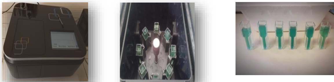
Figure 12: Spectrophotomètre et résultat du changement de couleur des échantillons.
