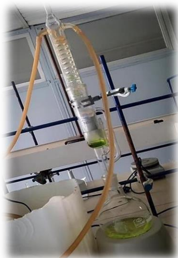
Figure 11: Montage d'un extracteur de Soxhlet
