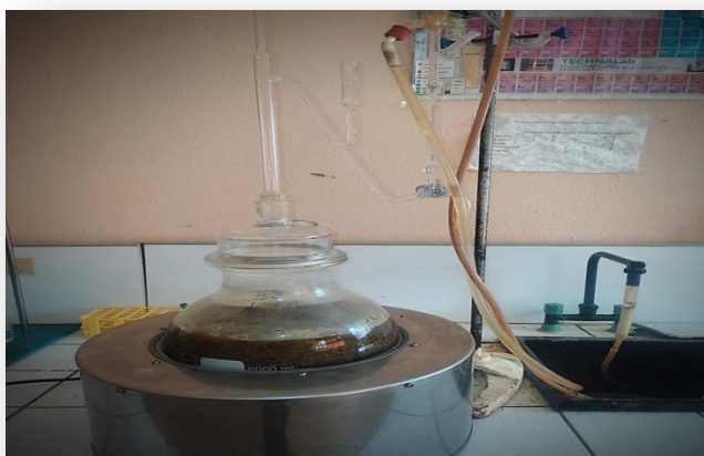
Figure 10:Montage d'hydrodistillation de type Clevenger.
