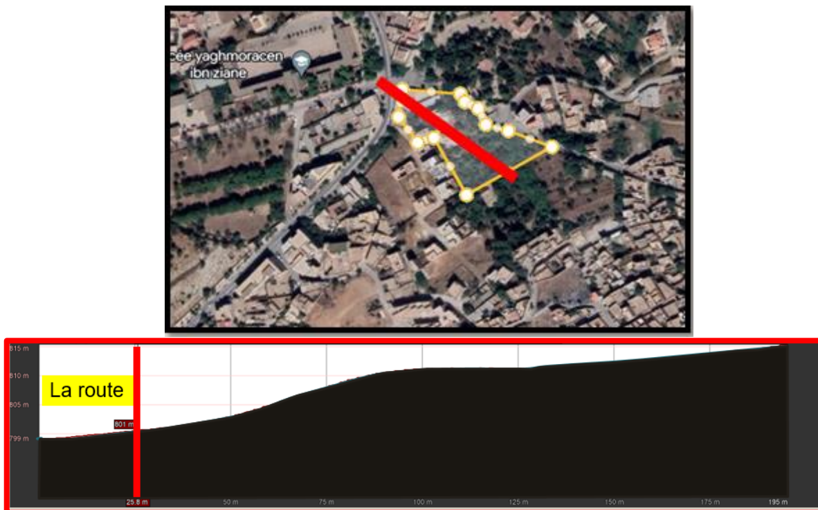
Figure 56: Coupes schématicque représentatives de la topographie du site d'intervention
