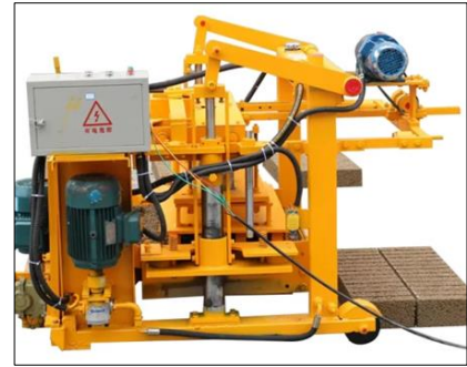
Figure 27: Une machine mobile pour réaliser des blocs en pisé
