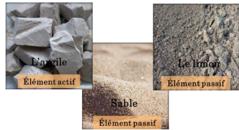
Figure 24: Les matériaux constructifs de ksar ben Haddou de Maroc
