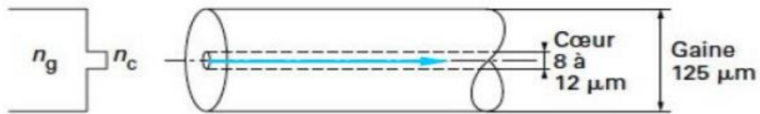
Figure I.4 Propagation de la lumière dans une fibre optique monomode [9]
