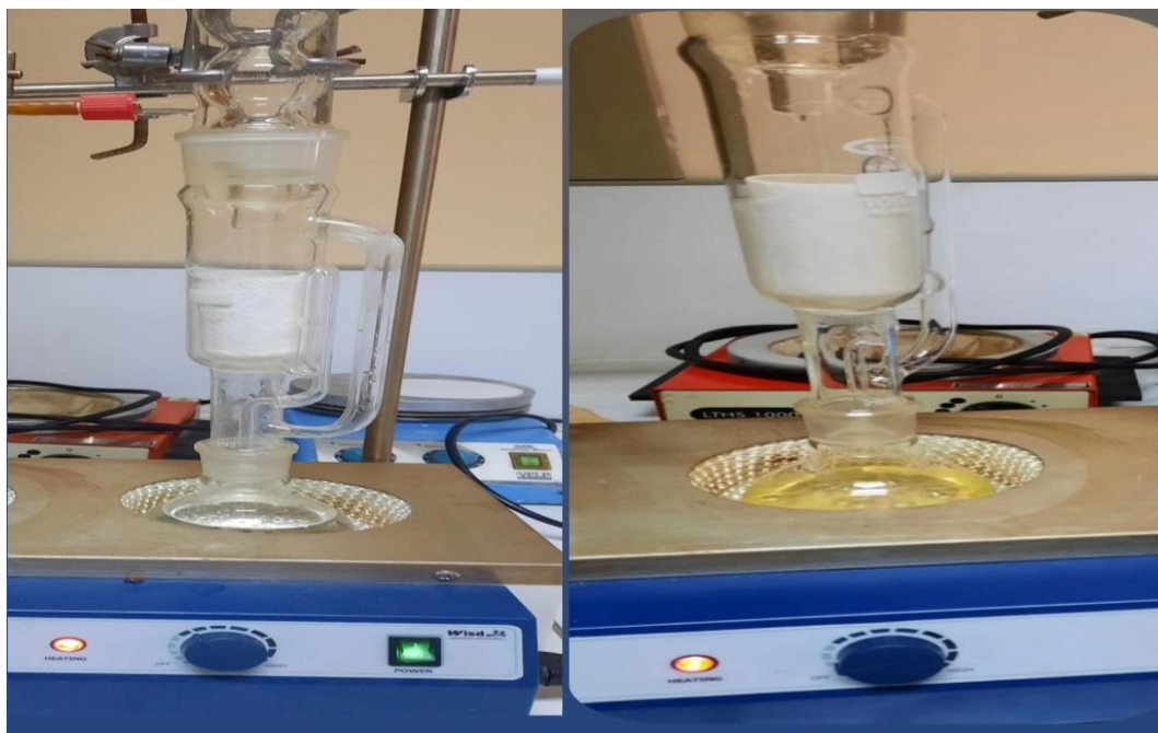
Figure 4: Le montage de soxhlet (A/ avant l'extraction par soxhlet ; B/après l'extraction par soxhlet)
