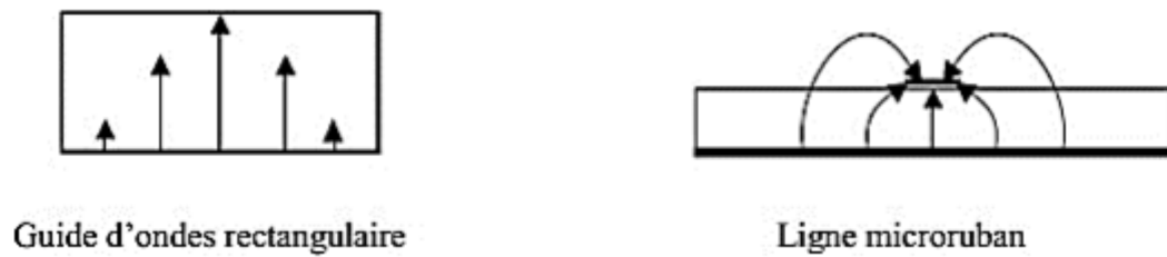
Figure I.14: Lignes de champs dans un guide d'onde rectangulaire et dans une ligne micro-ruban [20]
