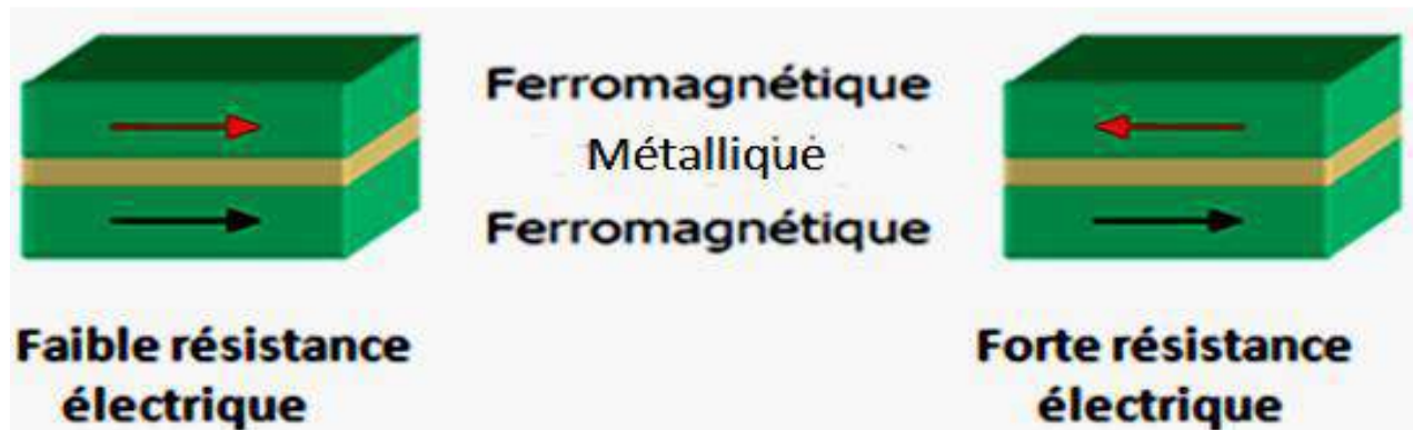
Figure I.1: les deux états, parallèle et antiparallèle, dans une jonction géante magnétique.
