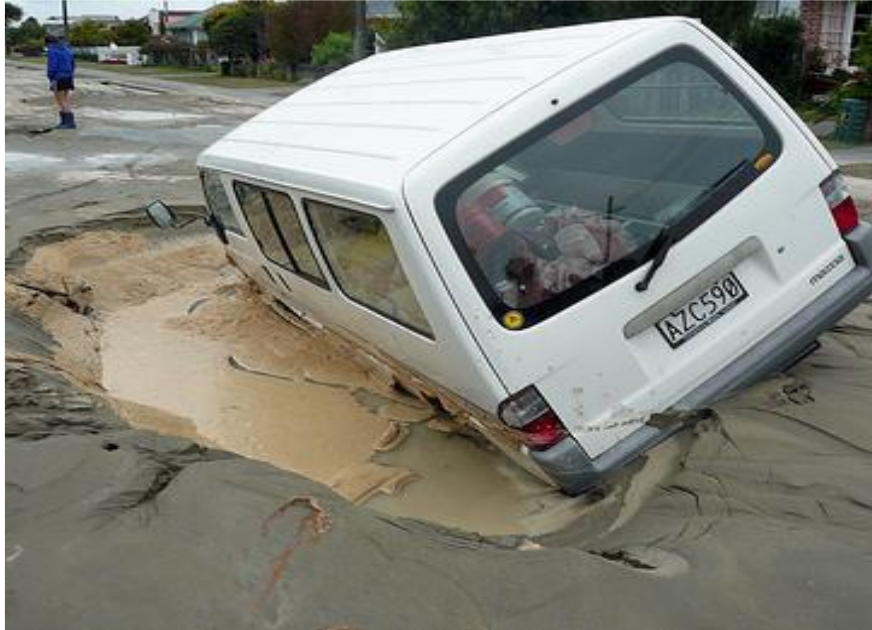
Figure I.10. Une camionnette qui malheureusement conduit dans un trou causé par la liquéfaction, du Nord de New Brighton, lors du séisme de Christchurch (2011)
