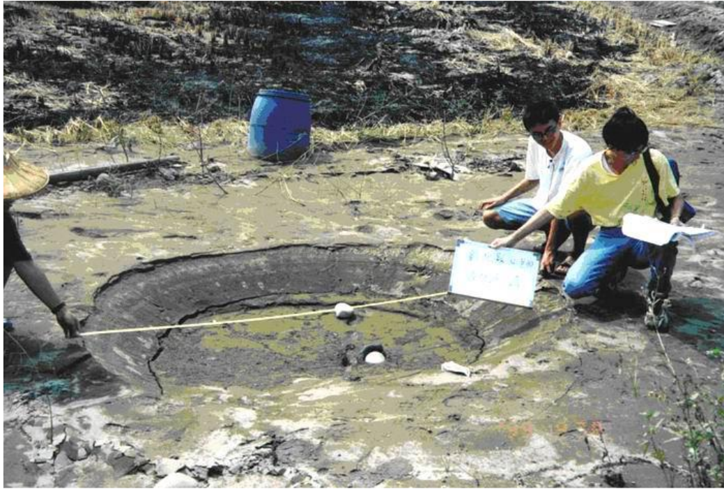
Figure I.9. Ebullitions de sable de Zhanghua (à droite) en Taiwan (d'après Dr Hsein, 2002).
