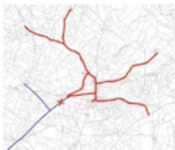
Casse d'une canalisation de forte criticité impactant une grande partie du réseau
