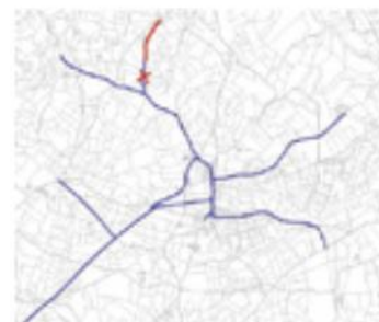
Casse d'une canalisation de faible criticité impactant peu le réseau
