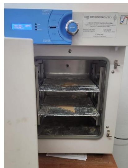
Figure 8 : photo de l'échantillon à l'intérieur de l'étuve (source : auteurs)
