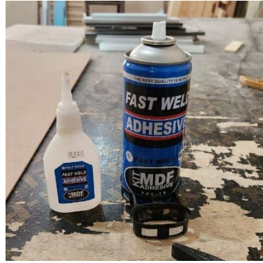
Figure 14 : photo de la colle de fixation des modules au support (source : auteurs)
