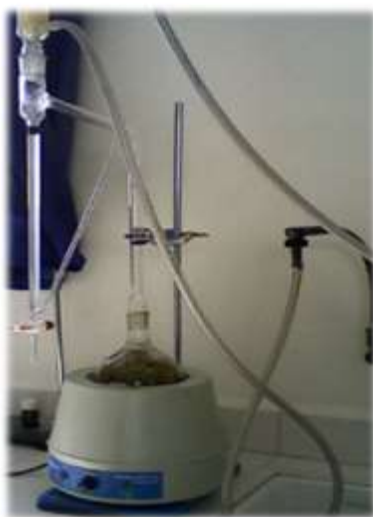
Figure 11. Dispositif de l'extraction des huiles essentielles de type Clevenger.
