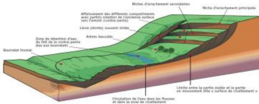
Figure 1-9 : Illustration des caractéristiques d'un glissement de terrain.
