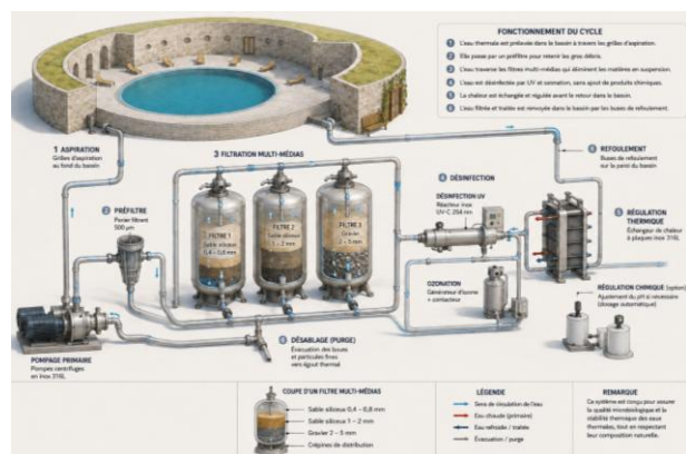
Figure 59 : Système de filtration de la piscine thermique
