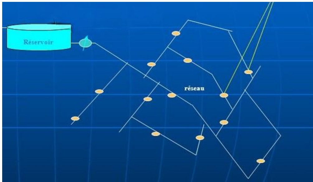
Figure 5: Schéma d'un réseau mixte [16].
