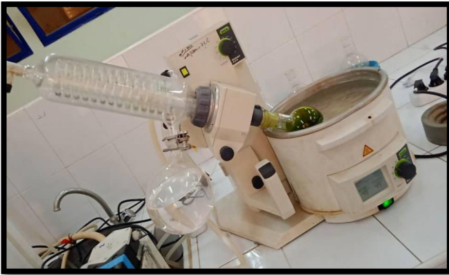
Figure 09 : évaporation par évaporateur rotatif.
