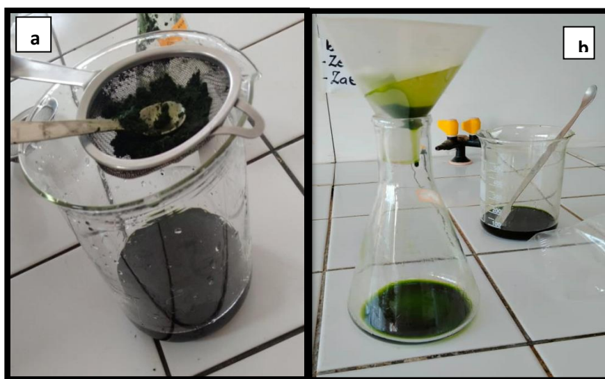
Figure 08 : Filtration : (a) à l'aide d'une passoire, (b) à l'aide de papiers filtres
