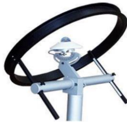
Fig. 1.2 : Pyranomètre muni d'une bande pare-soleil [5].
