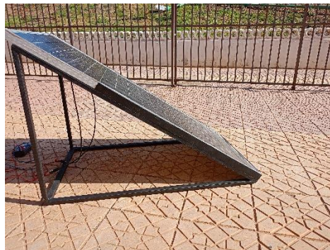
Fig.2.7 : Support métallique pour panneau solaire.
