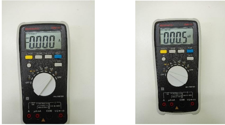
Fig.2.11 : La mesure de courant et de la tension par le multimètre digital.
