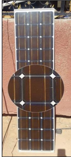
Fig. 1.13 : Exemple de la décoloration de l'EVA dans un module photovoltaïque du type UDTS-50 [16].
