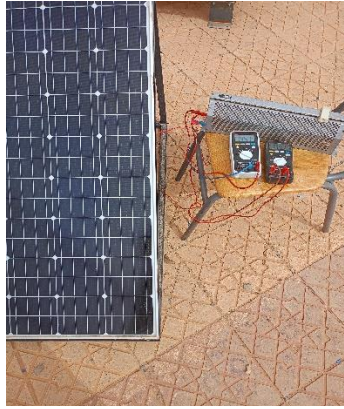
Fig.2.13 : Schéma du dispositif réel de la mesure des caractéristiques.
