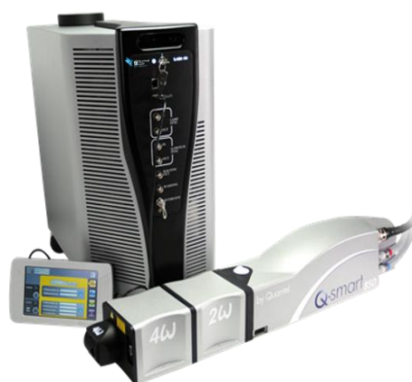
Figure V-5 : Laser Nd-YAG Q-Smart 850 équipé des modules de génération d'harmoniques de deuxième et troisième ordre avec alimentation et interface tactile Q-Smart.
