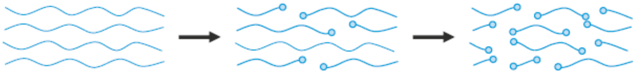
Figure I.18: Processus de coupure des chaînes macromoléculaires [41]
