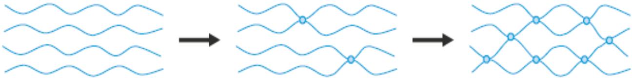
Figure I.19: Processus de réticulation des chaînes macromoléculaires [41]
