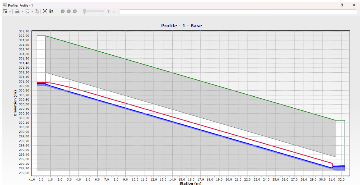
Figure IV.50 : Profil en long de la conduite (Polyline 214)
