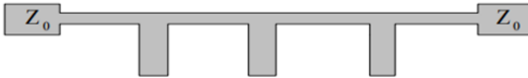
Figure I.16 : Structure d'un filtre à stub en micro-ruban [13].
