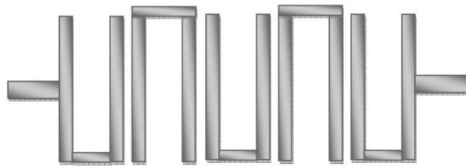
Figure I.18 : Structure générale d'un filtre à résonateurs couplés en parallèle [14].
