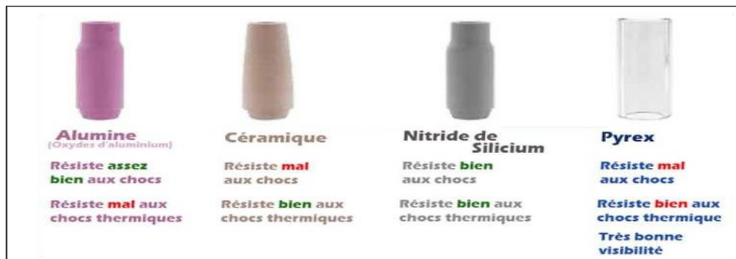
Fig 11. Différents types de buses [23]
