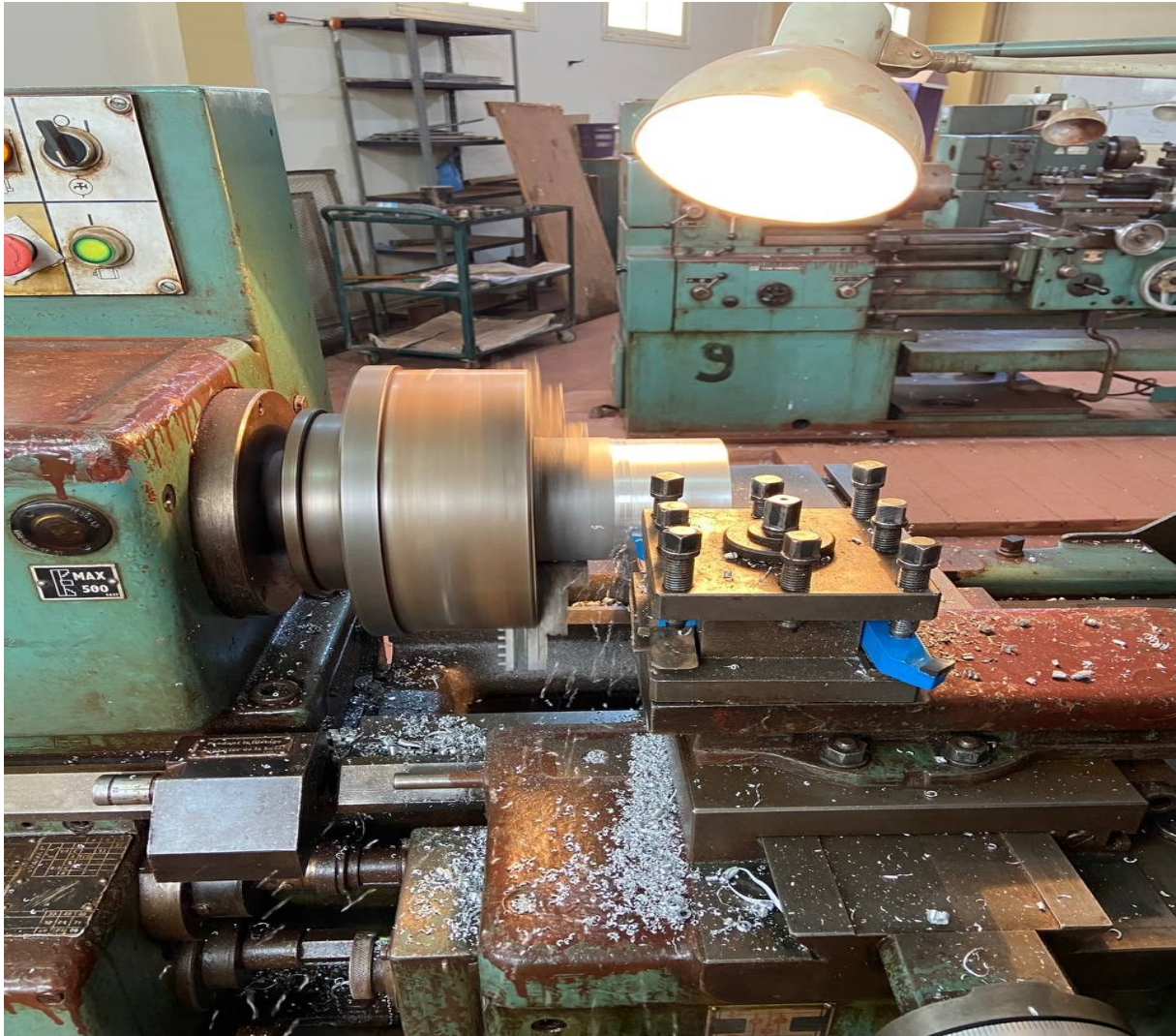
Figure IV.3 : Opération de chariotage
