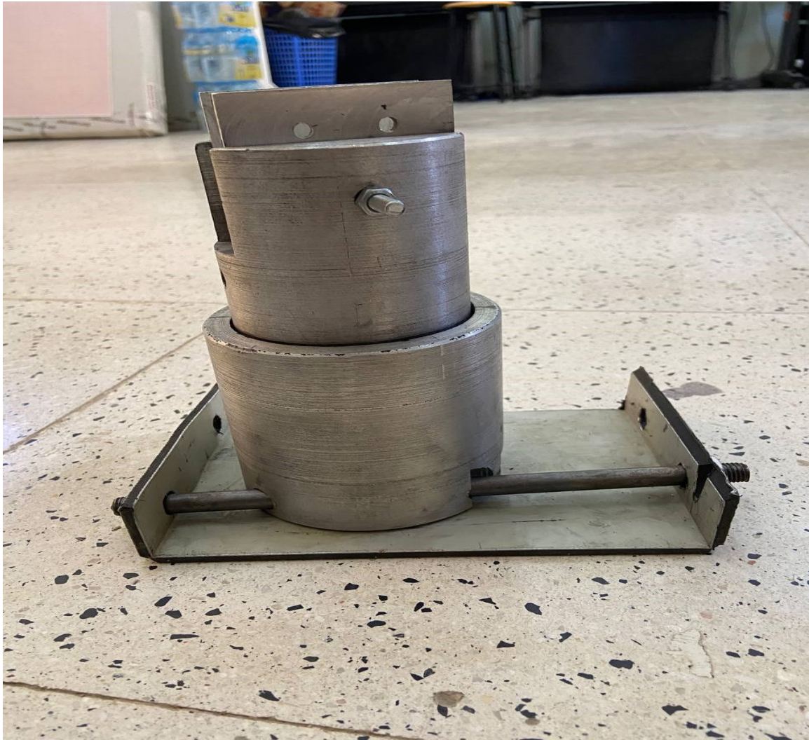
Figure IV.12: Vue d'ensemble de l'étau orientable réalisé en atelier
