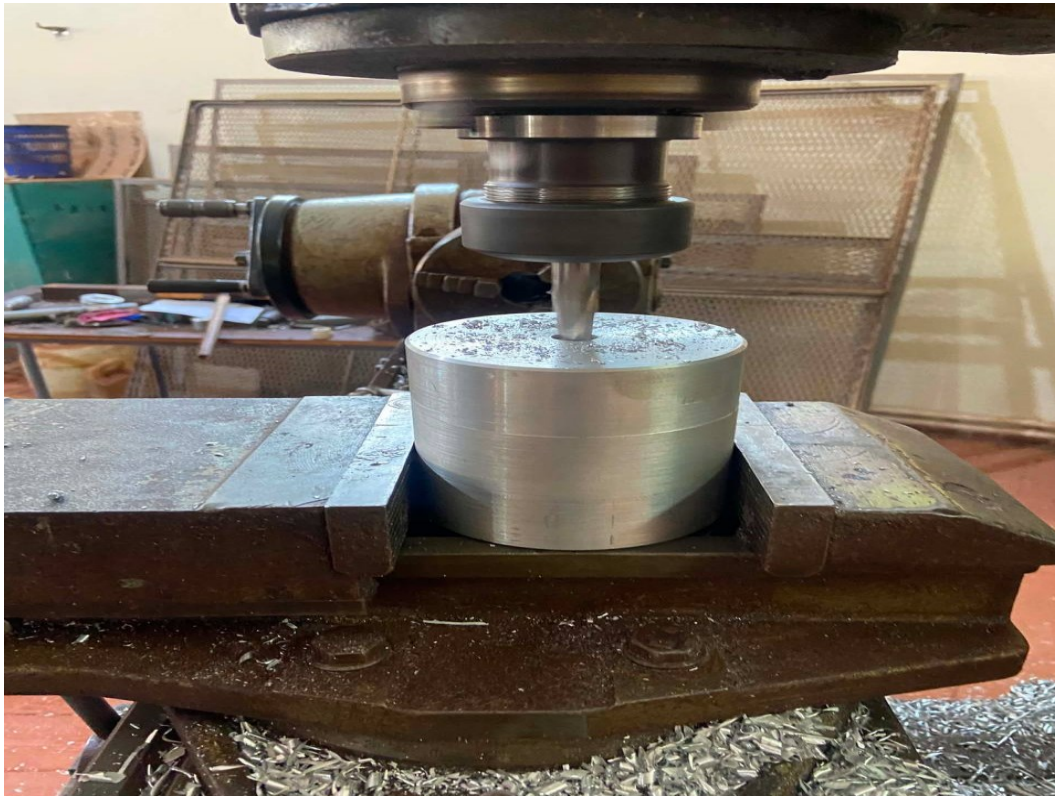
Figure IV.6 : Opération de rainurage sur la fraiseuse
