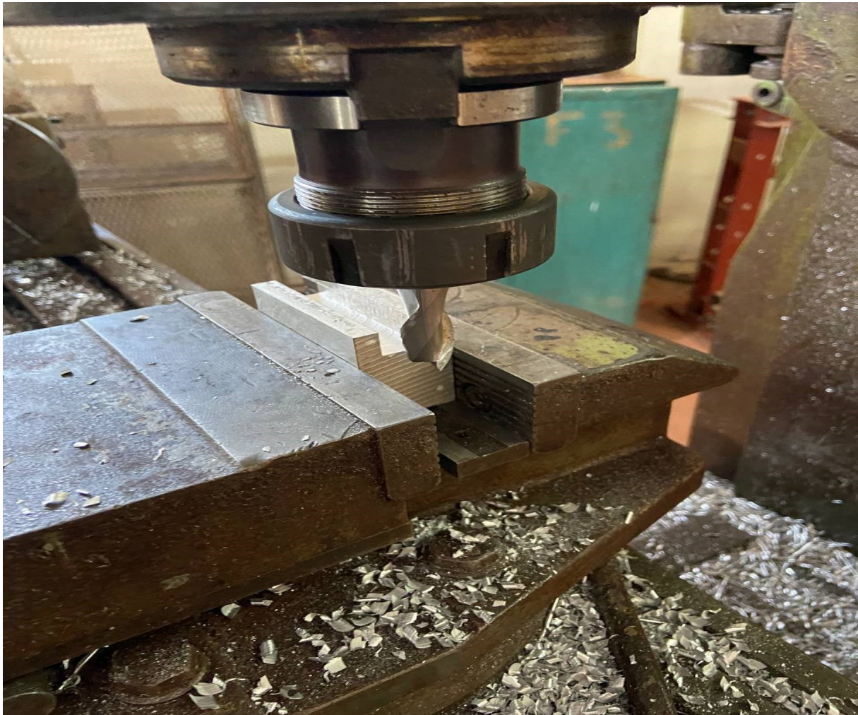
Figure IV.8: Opération de rainurage du porte-outil sur la fraiseuse
