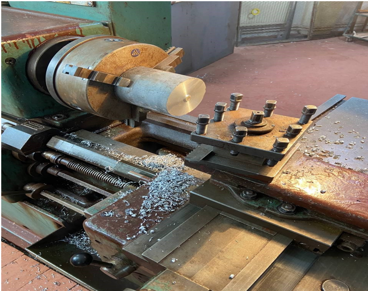
Figure IV.2 : Opération de dressage du brut sur le tour
