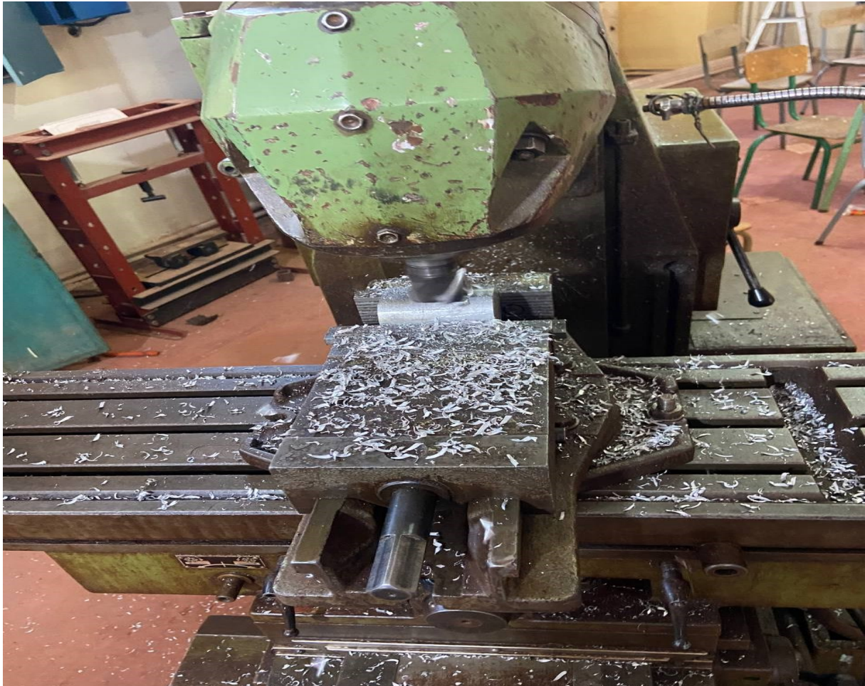
Figure IV.7 : Opération de surfacage du porte-outil
