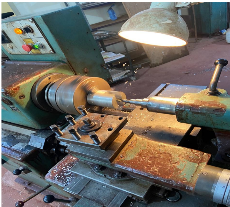
Figure IV.4 : perçage avec foret Ø16 mm
