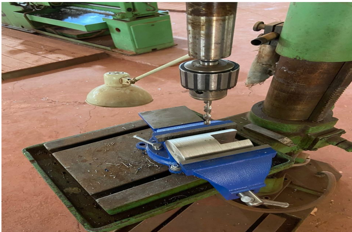
Figure IV.9 : Opération de perçage
