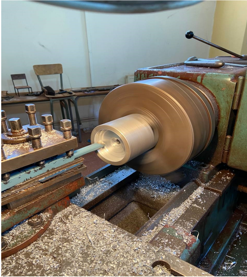
Figure IV.5 : Opération d'alésage avec outil à alése
