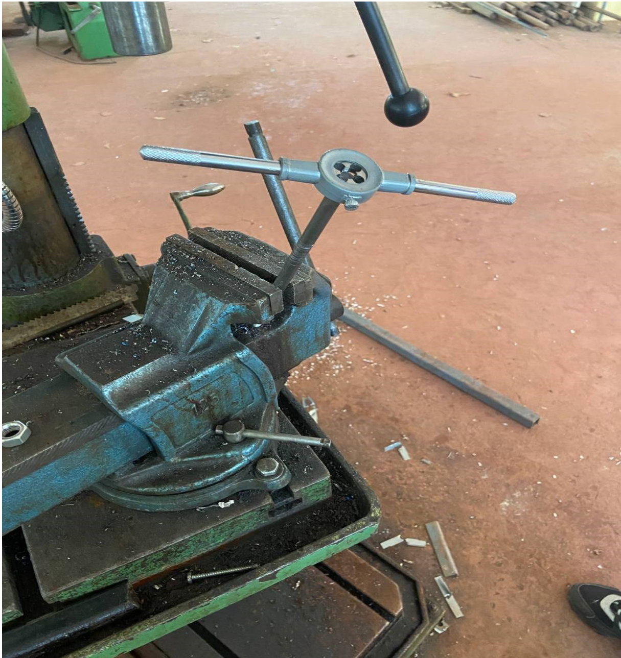
Figure IV.11: Opération de filetage manuel des tiges de guidage
