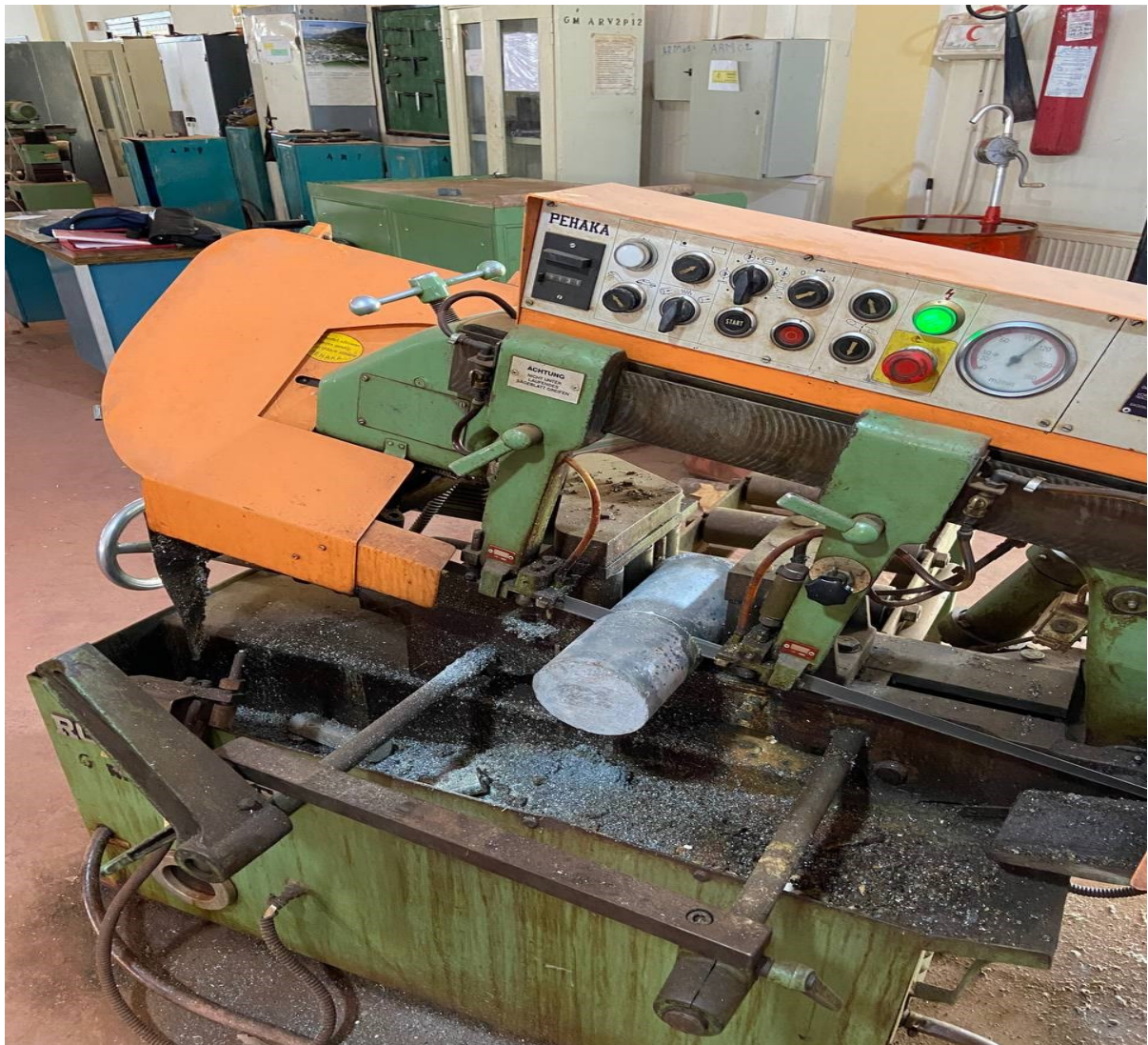
Figure IV.1 : Découpe du brut cylindrique en aluminium sur la scie à ruban
