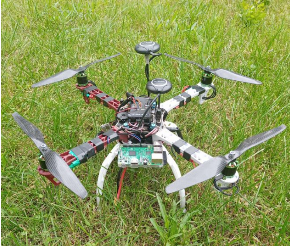
FIGURE 2.6.1 : Quadrotor développé pour la surveillance des cultures
