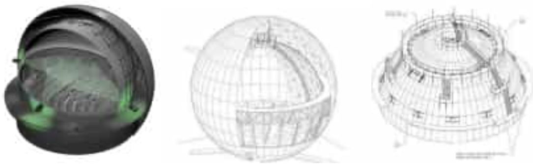
Figure 84. Système structurelle en tridimensionnelle du théâtre à dôme projet « Digistar 7 »
