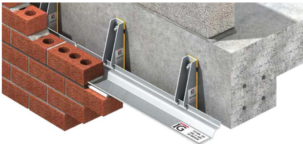
Figure 111 : Détail d'une Console métallique. (Source : IGlintels.com, NBS Library)
