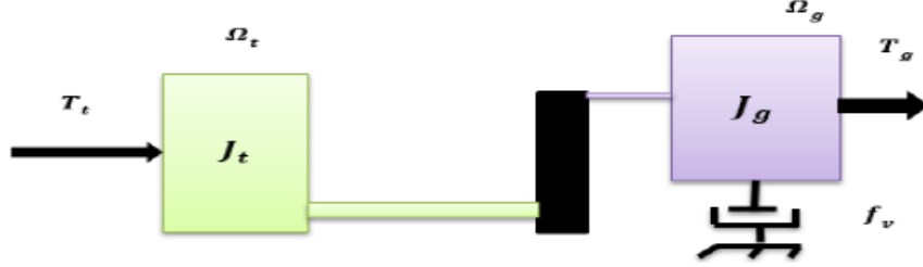
FIGURE 2.3 – Modèle mécanique de l'éolienne [19].
