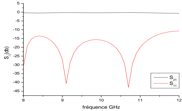
Figure II.11 : Paramètres S_{11} et S_{21} de RSIW dans la bande [8-12] GHz [5]
