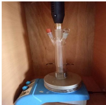
Figure II.8. Photoreacteur utilisé dans les réactions de photodégradation du polluant
