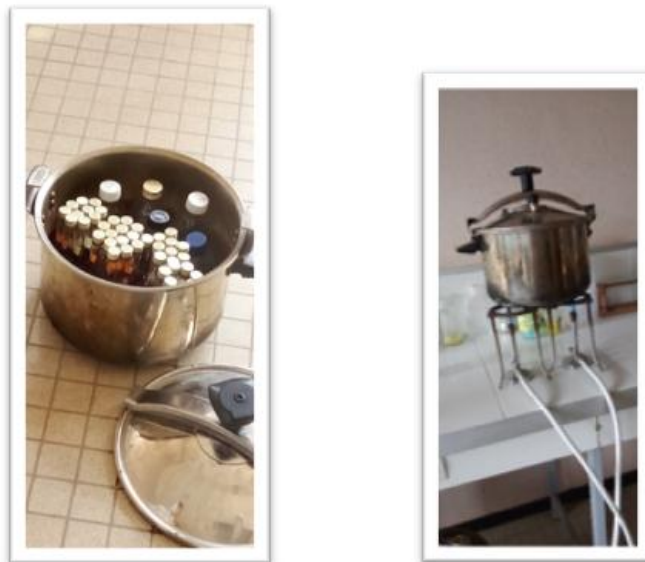
Photo Originale 08 :la stérilisation des flacons et des tubes.
