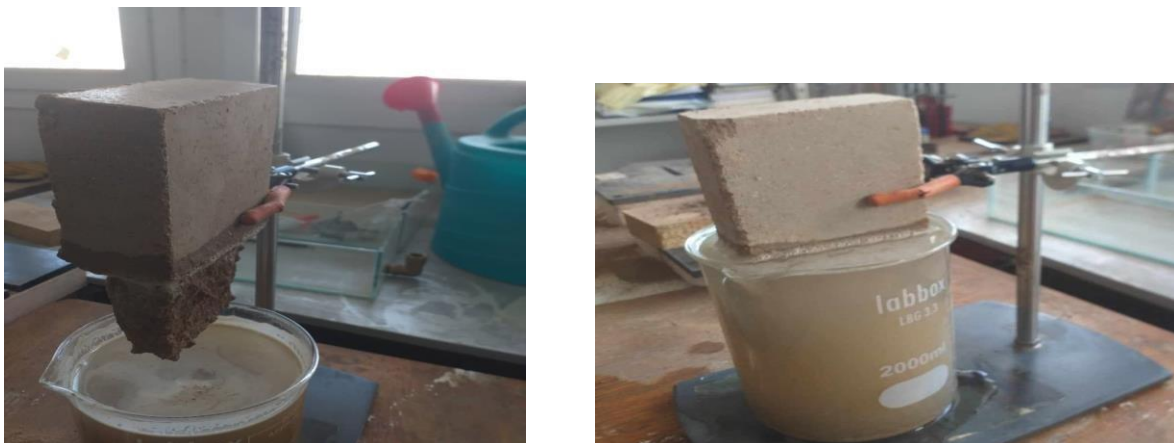
Figure II.16 Essai de tenue en eau par immersion
