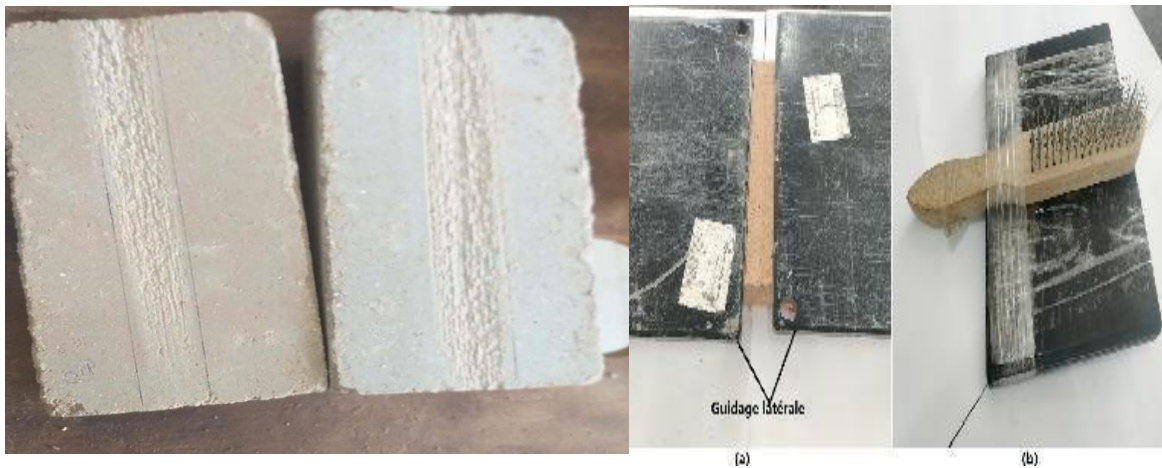
Figure II.17 Dispositif pour essai d'abrasion
