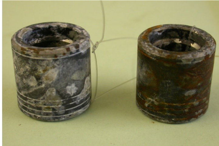
Fig. I-4 : corrosion inter granules
