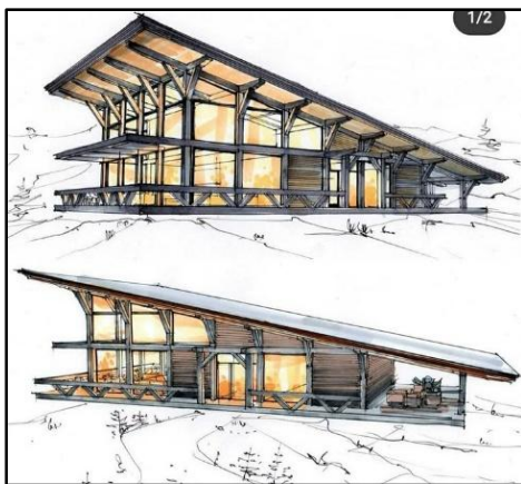
Figure 79. Toiture simple inclinaison
