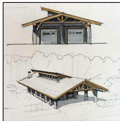
Figure 78. Toiture double inclinaison débordante
