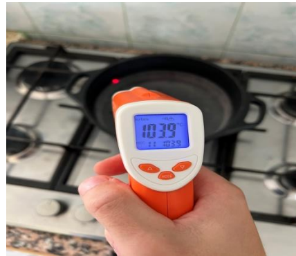
Figure 3.33 température mesuré pour l'étalonnage
