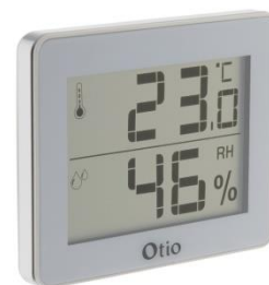
Figure 2.21 un hygromètre numérique
