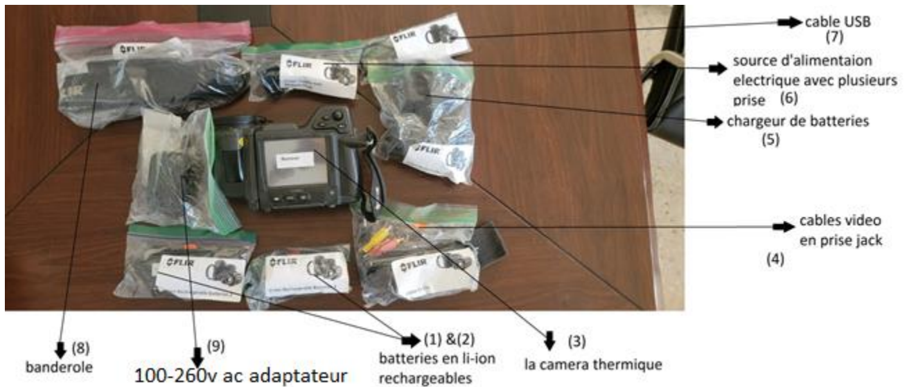
Figure 2.12 composants de la caméra thermique
