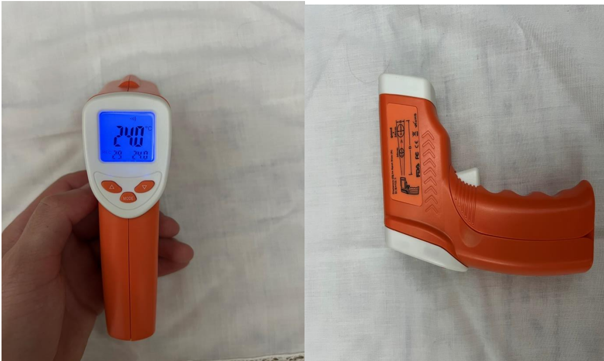
Figure1.6 pyromètre vue de profil
