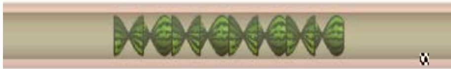
Figure II. 16. Géométrie de l'échangeur à double tube avec le turbulateur innovant [29]
