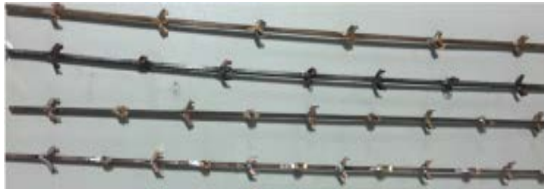
Figure II. 14. Schéma 3D du turbulateur incurvé innovant [27]
