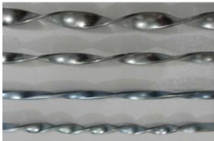
Figure II. 2. Disposition physique des bandes torsadées testées [13]
