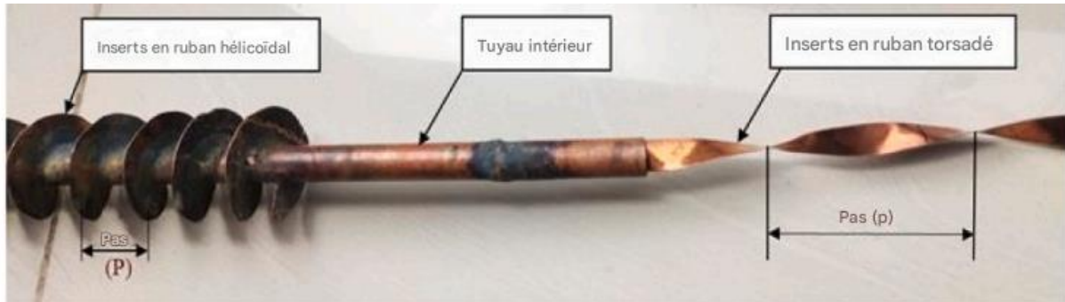
Figure II. 33 Photographie d'un ruban torsadé inséré dans un tube avec des rubans hélicoïdaux enroulés autour du tube [60]
