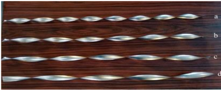
Figure II. 29 Ruban torsadé utilisé dans les travaux de Yadav et al. [56]
