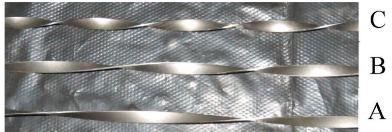
Figure II. 27 Rubans torsadés considérés par Hazim [54]
