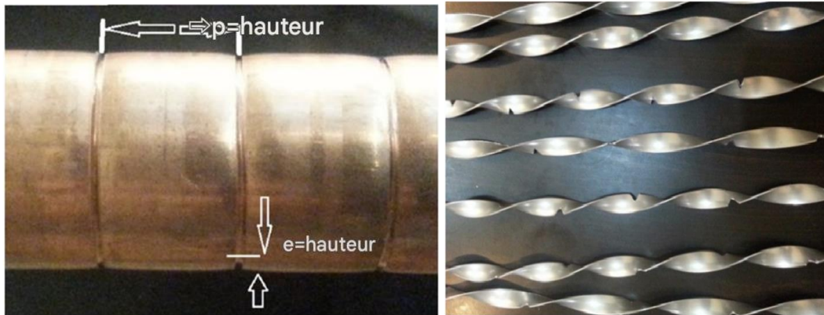
Figure II. 20 Géométrie de tube et rubans torsadés utilisé par Langeroudi et Javaherdeh [35]
