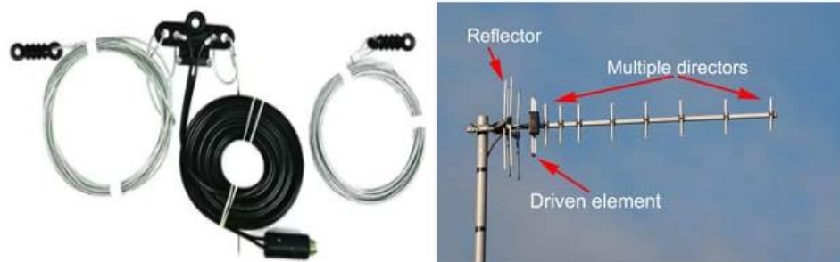
Figure II-4: Antenne Filaire & antenne Yagi.[32][33]
