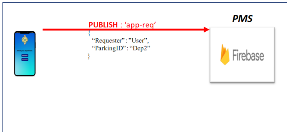
Figure III.51: L'application envoi une requête à PMS.
