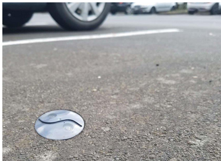
Figure II.7: Capteur sous-sol (Magnétomètre). [19]
