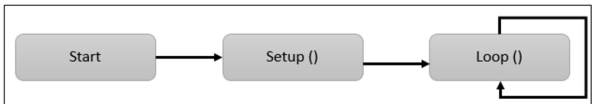
Figure III.16: Fonctionnement d'un programme Arduino.
