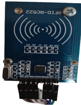
Figure II.6: Capteur d'identification par radiofréquence (RFID).
