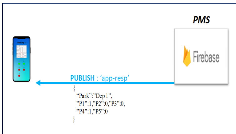
Figure III.45: PMS répond à la requête de l'application (parking dep1).
