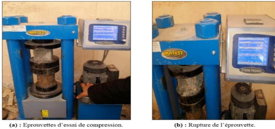
Figure 2 : (a) Eprouvette avant écrasement, (b) Eprouvette après écrasement (rupture)[57].
