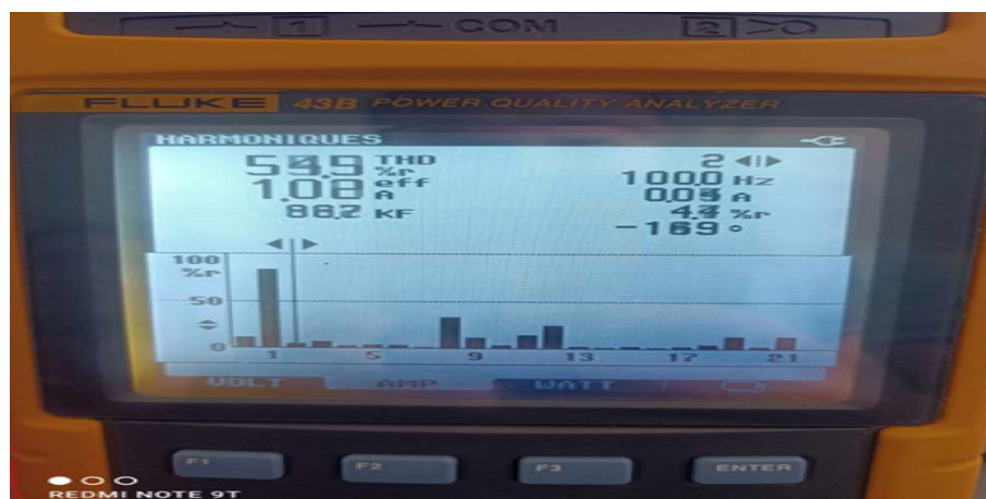
FIGURE IV.26 – THD et spectre d'harmoniques de courant pour m = 190
