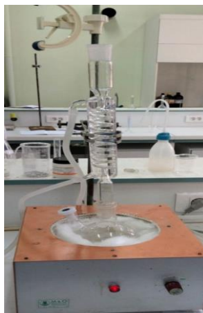
Figure 9 : Montage du chauffage à reflux.
