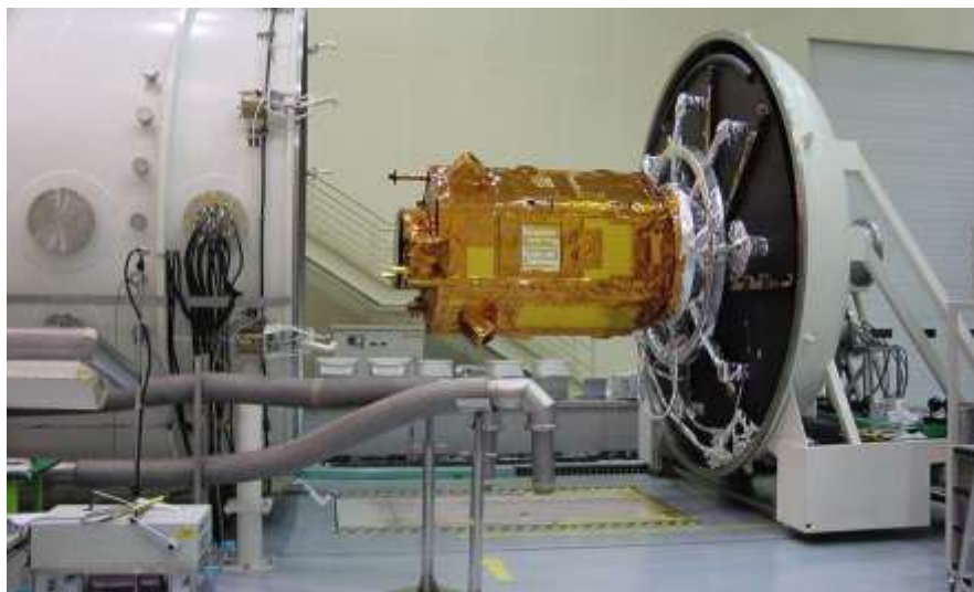
Figure I. 9: embarquement satellite au bord du moyen vide thermique pour essai VT [17].
