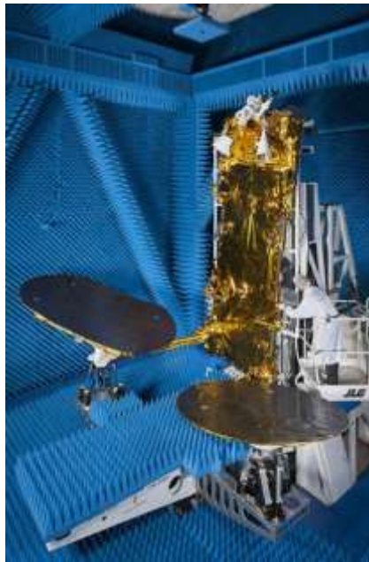
Figure I. 8; essais EMC dans la chambre anéchoïque [16].
