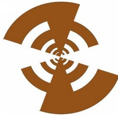
Figure II.6: Une antenne log-périodique Circulaire.
