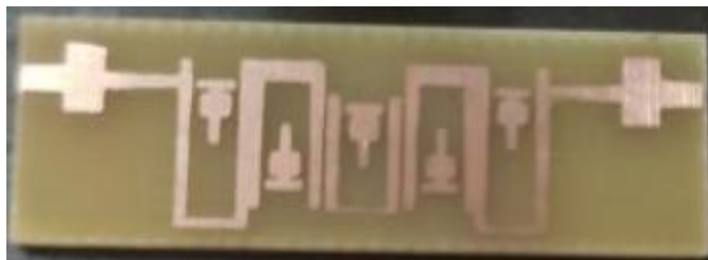
Figure IV. 42. Le filtre proposé réalisé.
