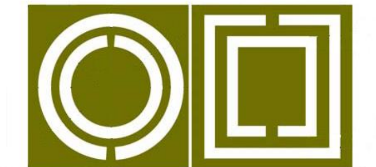
Figure II.16 : Un résonateur à anneau fendu complémentaire (CSRR)
