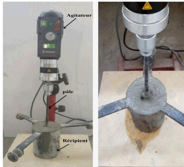
Figure II.7 : Dispositif de l'essai rhéologique (Belaidi et al., 2021).
