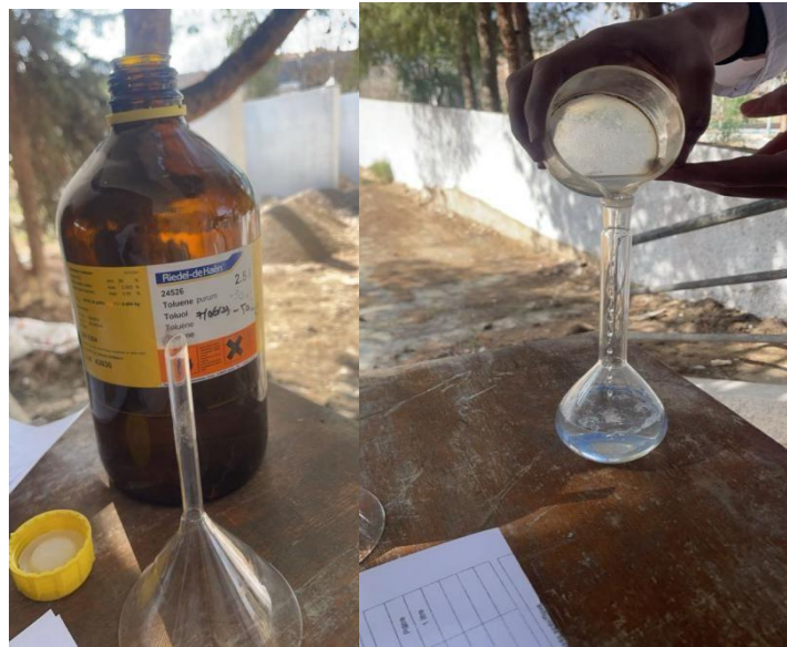
Figure III.2 : Détermination de la masse volumique absolue de ciment utilisant le Toluène.
