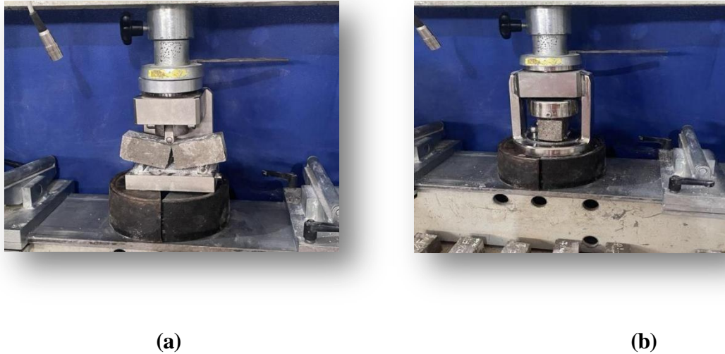
Figure III. 11 : Essais mécaniques en: (a) traction par flexion et (b) compression.
