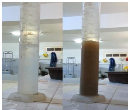
Figure III.4 : Essai de détermination de la Masse volumique absolue du sable.
