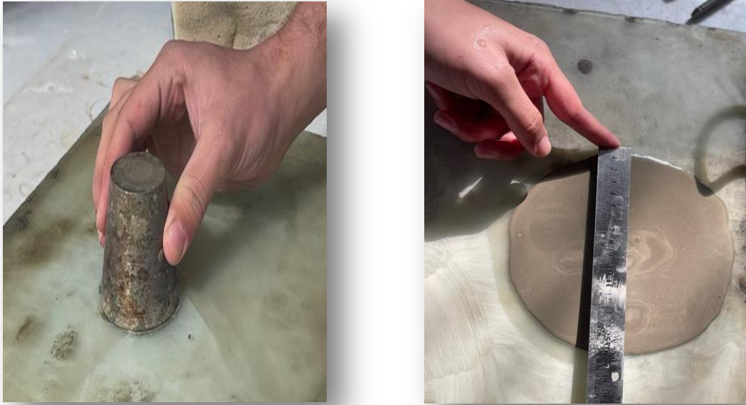
Figure III.7 : Essai du mini cône.
