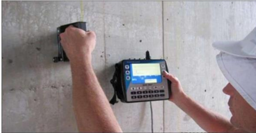
Figure 3. 3: test Choc-Echo avec appareil Olson's NDE 360 [15]
