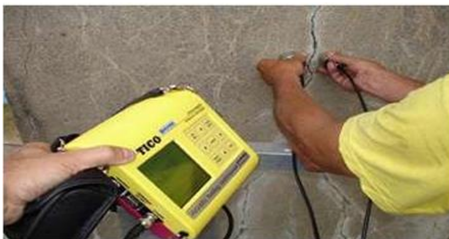
Figure 3. 4: l'auscultation sonique des bétons [15]
