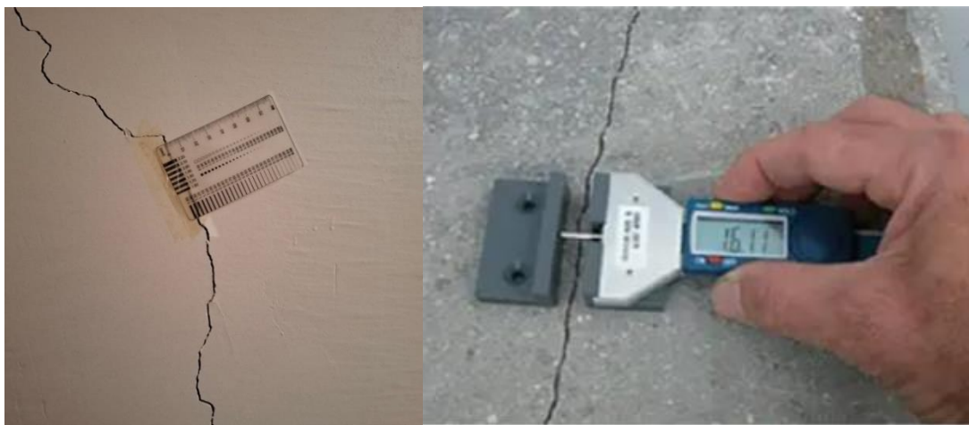
Figure 3. 2: fissuromètre –dispositif manuel [34] et numérique
