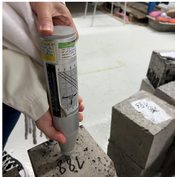
Figure 3. 5: scléromètre – mesure de la dureté d’une surface béton [35]
